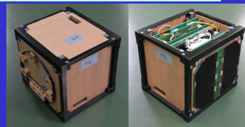
LignoSat 地上試験用モデル(EM)
