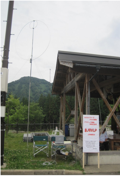
8J9VLPの運用で活躍した直径2,500mmの マグネチックループアンテナ 3.5MHz、7MHz、10MHz用
