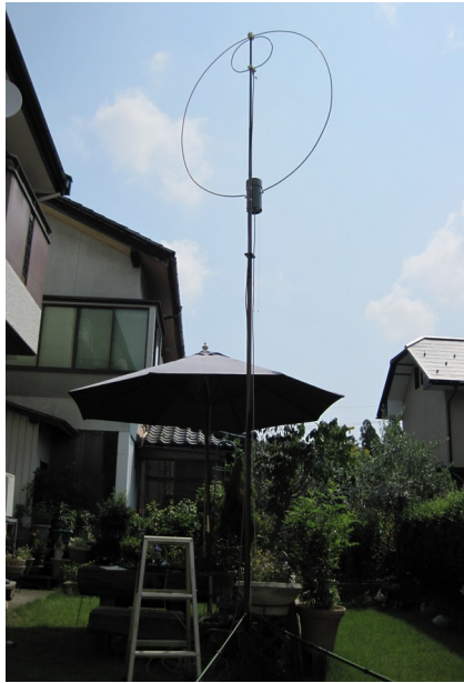
最近製作した直径1,300mmの マグネチックループアンテナ 7MHz、10MHz、14MHz、18MHz用
