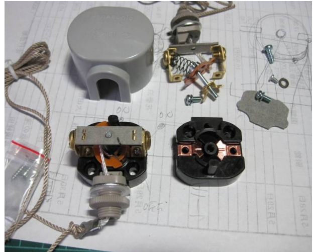
固定コンデンサー切替に使ったキャノピスイッチ 1個350円程で手に入る
